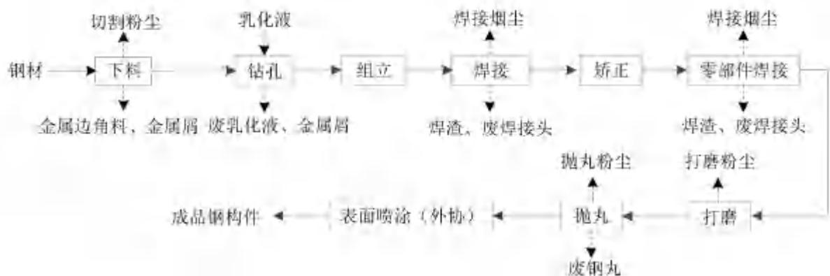
图 1.2-1 项目 H 型钢构件、箱型钢构件生产工艺流程及产污节点图
